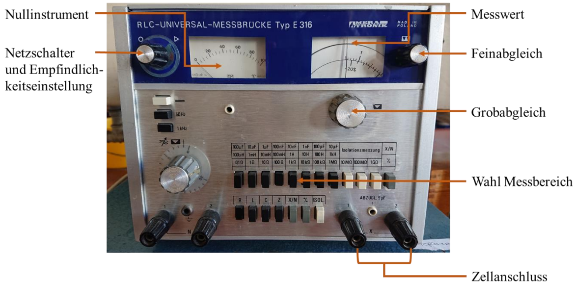
Abbildung 1: Bedienelemente der RLC-Messbrücke
